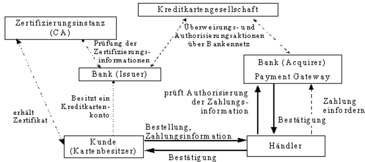
4. Händler schickt eine digital signierte Anfrage (erst DES [symmetrisches Verfahren] verschlüsselt und dann RSA verschlüsselt), dazu kommt das Verschlüsselungszertifikat des Händlers, die Zahlungsanweisung und der verschlüsselte DES-Schlüssel.
